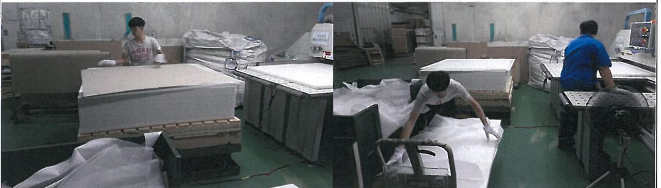
接著，**擔任副手的我**需要準備推車、泡棉、牛皮紙，把這些東西就定位後，再來是按照原料上面的刻度記號抓數量，因為每次處理的**板子厚度和尺寸大小**和使用的**刀具**都不一樣，所以抓的數量也會不太一樣。再來就是把原料協助搬上去機台做切割，切割完後搬到推車上再鋪泡棉。泡棉的用途是讓每板子之間**不要有摩擦受損**。牛皮紙的用途是墊在切割原料的最下面，讓板子**不要有毛邊**。
