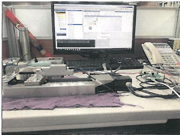
圖 1 步進馬達位置反覆精度測試
