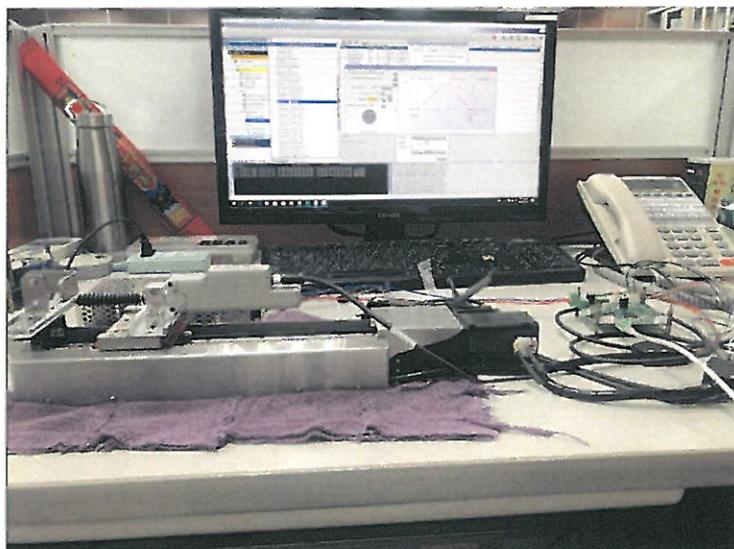
圖 6 步進馬達位置反覆精度測試
