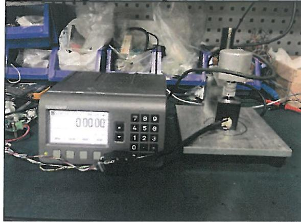
圖 16 步進馬角度測試
