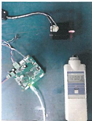
圖 1 步進馬達速度測試
