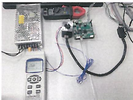
圖 4 步進馬達溫升測試
